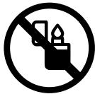
En caso de fuga de gas, debe cerrar la válvula del manorreductor. Nunca compruebe si hay una fuga de gas prendiendo una llama, aunque la bombona parezca estar vacía, puede quedar gas. No utilice esta estufa con un programador, un temporizador o cualquier otro dispositivo que encienda la estufa automáticamente, ya que existe un riesgo de incendio si la estufa está cubierta o colocada incorrectamente. Utilice siempre la estufa y la bombona en una superficie plana y estable.
